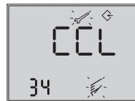
Schließrichtung (Drehrichtung, durch die die ZU-Stellung des Stellventils erreicht wird; Blickrichtung auf Display des Stellungsreglers) Standard: CCL
