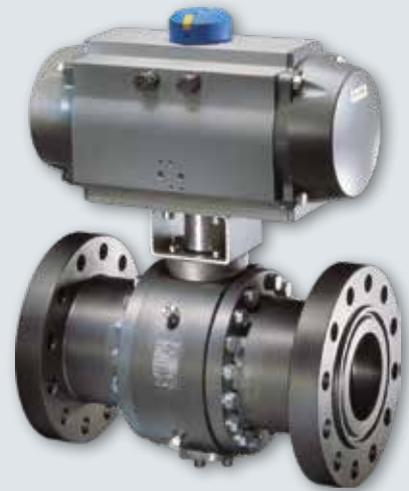
**SAMSON VETEC** – Das Maxifluss-Stellventil von VETEC vereint die Stärken von Stellventilen, Stellklappen und Kugelhähnen. Die universelle Konstruktion ermöglicht den Einsatz bei Standardapplikationen bis hin zu kritischen Anwendungen. Dank seiner exzentrischen Lagerung berührt der Drehkegel den Ventilsitz nur beim vollständigen Schließen. Das Ventil kann daher mit großem Stellverhältnis regeln.
